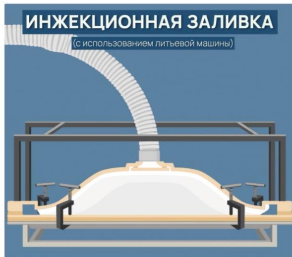
Инжекционная заливка ULGRAN Quartz
